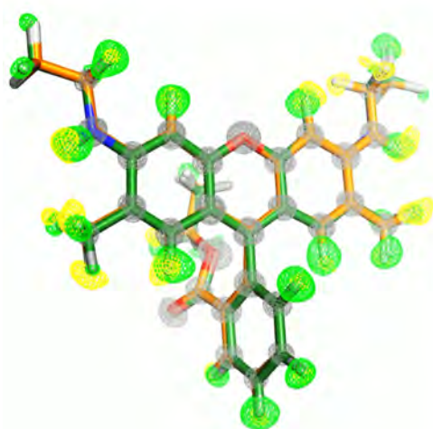
図4 蛍光分子ローダミン 6G の結晶構造の重ね合わせ。緑は XFEL、黄色は電子回折の測定データからそれぞれ得られた水素原子を表す。水素原子は、XFEL では結合相手の原子により近い位置に観察される。水素以外の原子位置 (灰色) はほぼ一致する [2]。
