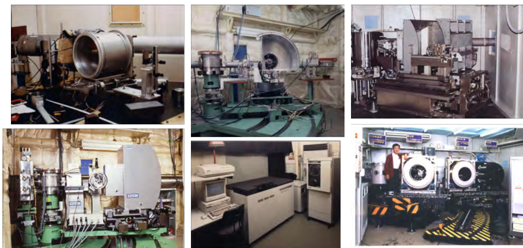
図 1. PF に設置された巨大分子用ワイセンベルグカメラと イメージプレート読み取り装置
